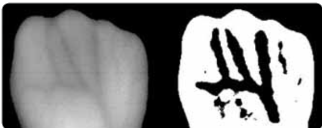
Obr. 18 Lokální prahování obrazu hřbetu ruky
