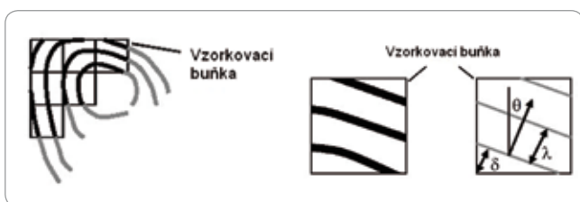
Obr. 32 Vzorkovací buňky a zjišťování sklonu linie \theta , odstupů linií \lambda a odstupů od okraje buňky
